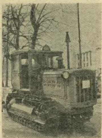
Украинская ССР. Харьковский тракторный завод создал образец нового гусеничного трактора «ХТЗ-20» мощностью 54 лошадиные силы. Трактор «ХТЗ-20» годится для использования как в сельском хозяйстве, так и на строительных работах.
